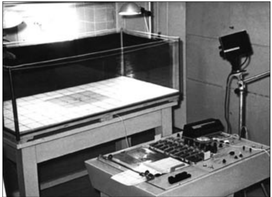
Рис. 1. Полуавтоматическая установка для исследования индивидуальных особенностей мелких лабораторных животных в тесте «открытое поле».
